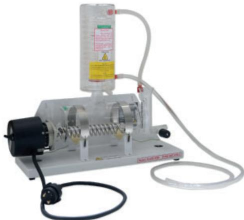
1 | Le distillateur en verre BASIC PH4 est spécialement conçu pour la distillation en continu et en toute confiance. Facile à utiliser, il fonctionne en toute sécurité: il est muni d'un thermostat de sécurité.
